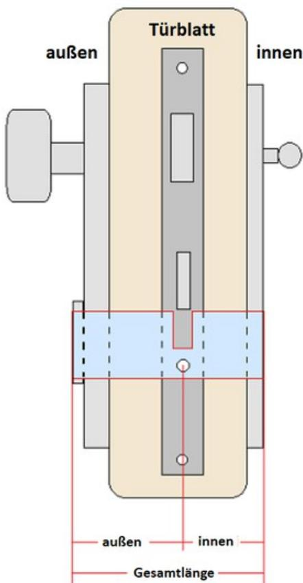
Zur Ermittlung der korrekten Länge Ihres Profilzylinders (hellblau dargestellt), messen Sie jeweils von Mitte Befestigungsloch (M5) bis zum Ende des Profilzylinders bzw. bis zur Türbeschlag-Außenkante (rot skizziert). Innen- und Außenlänge ergeben die Bau-
